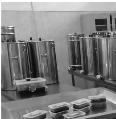
Ilustração 14 - Extração de mel por escorrimento
