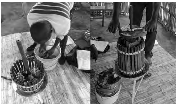
Ilustração 12 - Extração de mel por prensagem
