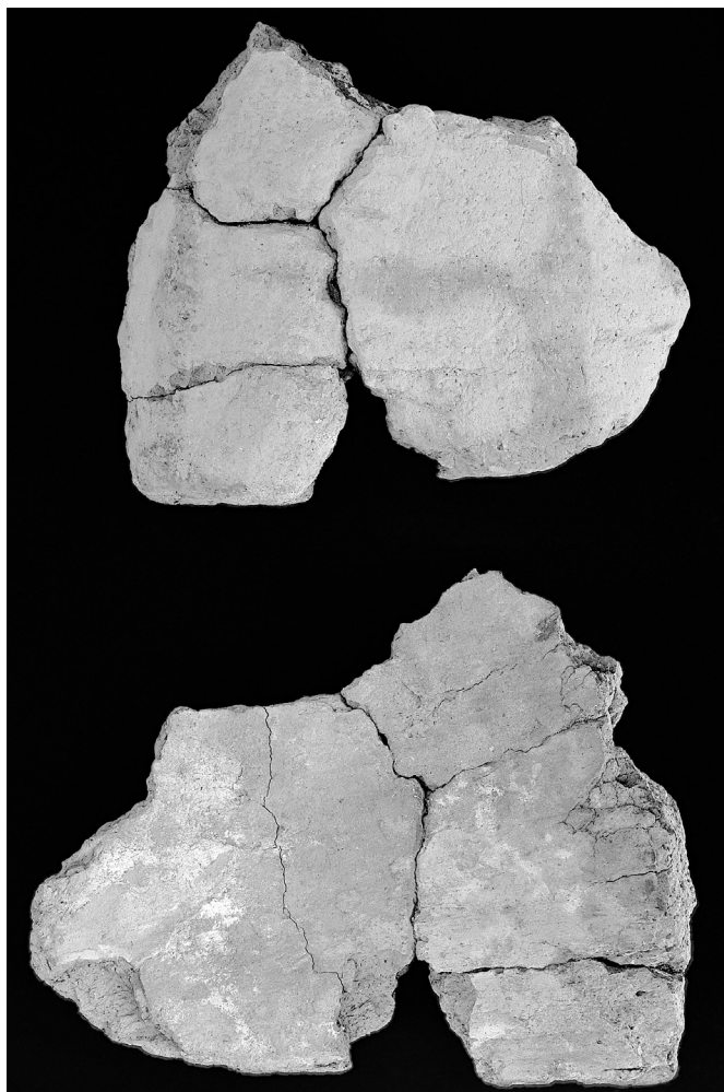
Fig 12. Mosteiro de Santa Maria de Pombeiro – face interna e externa de um fragmento de capa do sino maior identificado. Note-se na face exterior a marca da disposição das cordas usadas para a colocação do molde na fossa de fundição
