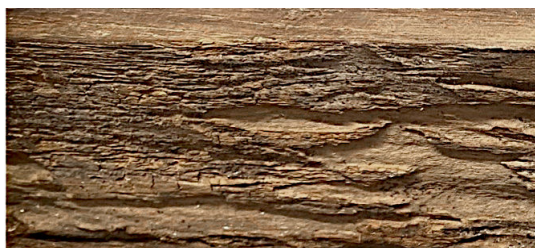
Fig. 8. Detalhe de podridão cúbica numa das tábuas laterais do acrescento da moldura
