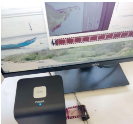
Figura 12 – Processo de digitalização de película de 35mm
