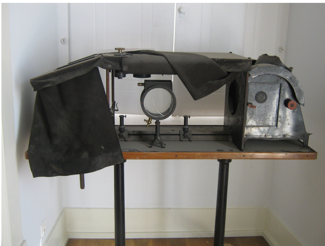
Imagens 6 — 7. Montagem para a fotomicrografia da Zeiss, 1889 [em cima]; Mesa com banco de óptica e com caixa para a lâmpada de arco, MUHNAC-ULoo4481, fotografia da autora (Cortesia MUHMAC) [em baixo].
