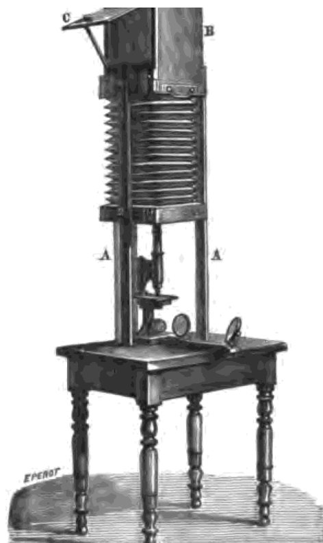
Imagem 2. Aparelho vertical para fotomicrografia (Robin, 1877: 435).
