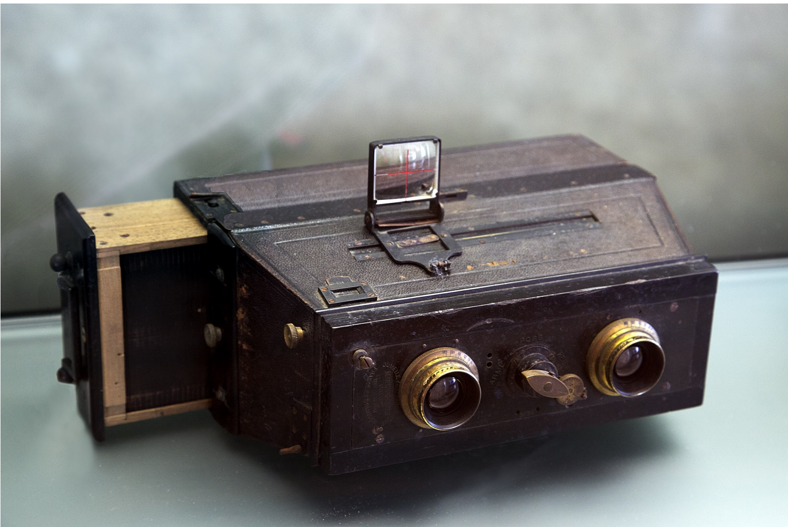
Imagem 15. Câmara estereoscópica de Aurélio da Paz dos Reis. Mackenstein, Paris, França, ca. 1906. Conforme exposta no Núcleo Museológico António Pedro Vicente no CPF, Porto. Objectivas Carl Zeiss f: 1.8/110 mm, obturador de uma velocidade e pose; visor desportivo recolhível; corpo de madeira forrado a couro. Prova fotográfica da autoria de Renato Roque.
