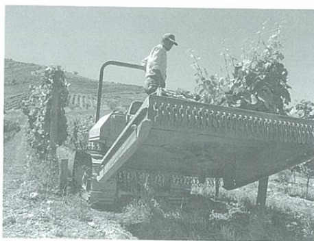
Fig. 26 | Roçadora de facas escamoteáveis
