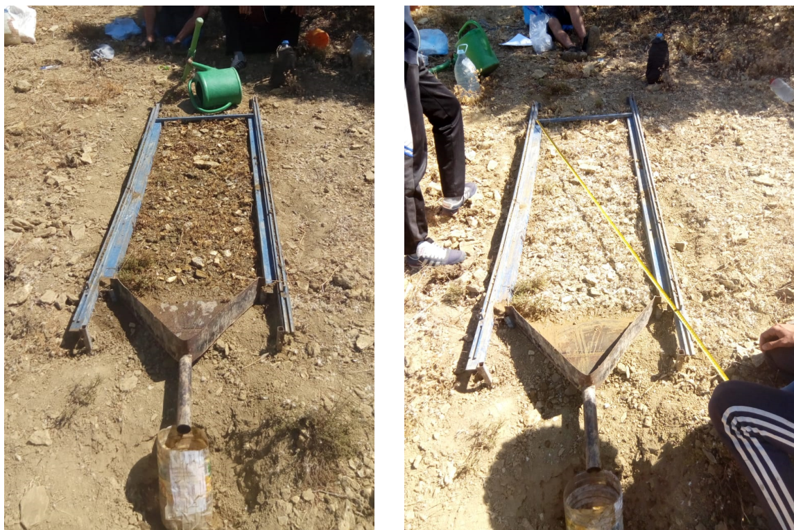
Figure 1 Mini-simulateur de pluies à rampe
