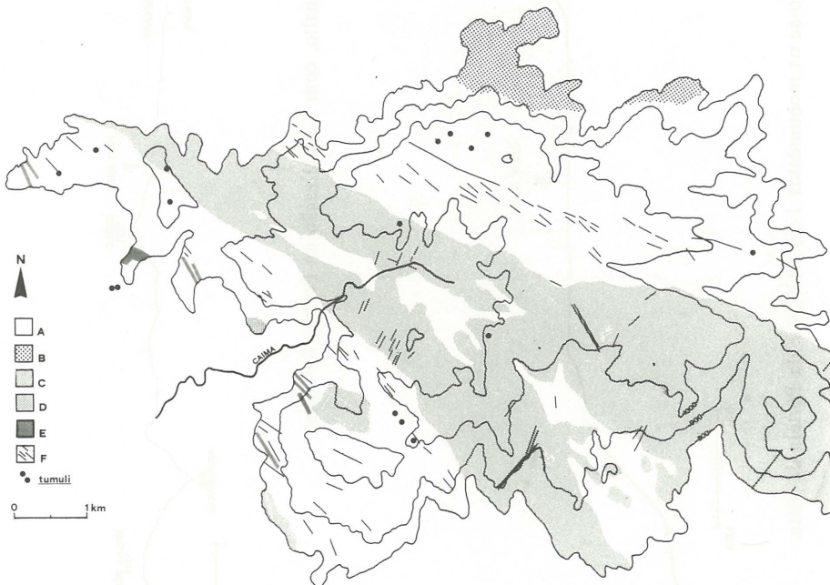
2 — Esboço litológico do planalto (seg. Pereira et al. , 1980). Legenda: A — xisto argilosos, grauvacóides e quartzitos cinzentos; B — quartzodiorito biotítico; C — granitos de tendência alcalina, com duas micas, de grão médio; D — Idem , de grão fino; E — microgranitos alcalinos; F — filões de quartzo.
